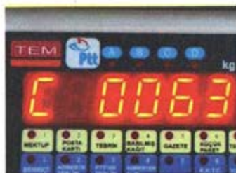
Contorul intern de service afișat la pornire
