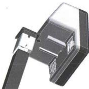
Atașați indicatorul pe braț așa cum vă arată în imaginea de mai sus. Nu scoateți indicatorul după ce a fost conectat la platformă. Ca să scoateți indicatorul de pe braț scoateți cele două șuruburi de lângă conectorul brațului.
